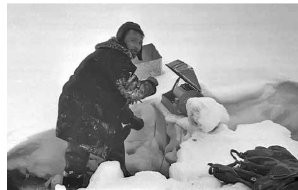
36. В. Н. Нечаев выполняет техническое обслуживание самописца «Валдай» у гейзера Щель. Начало 1975 г. Фото В. Л. Леонова.
