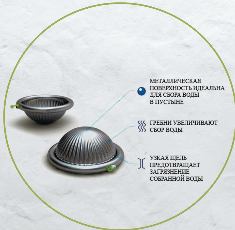
Система сбора и хранения воды, получаемой из тумана
